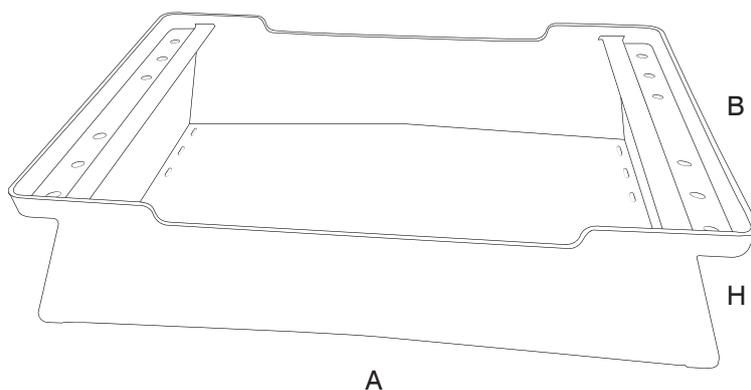
Der stapelbare Behälter ZETA 2 ist dank seiner Struktur mit geneigter Innenfläche und den Abflusslöchern am Boden speziell für alle Prozesse konzipiert, bei denen Flüssigkeiten abgelassen werden, wie zum Beispiel: Lebensmittelindustrie und Fisch.
