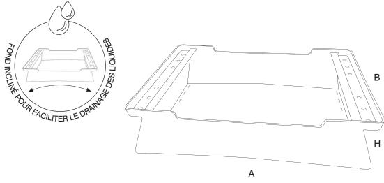
Le conteneur empilable ZETA 2, grâce à sa structure avec une surface interne inclinée et les trous de drainage situés sur le fond, est spécifiquement conçu pour tous les processus qui impliquent le drainage de liquides, tels que: les industries alimentaires et de la pêche.
