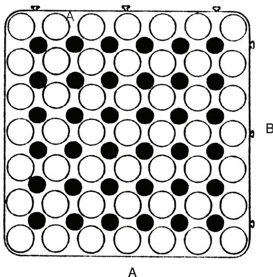
Les éléments modulaires Sigma fabriqués avec des résines antichocs spéciales vertes sont particulièrement indiqués pour les sols d'industries graphiques et mécaniques car ils sont en mesure d'absorber au maximum les vibrations des installations et d'en étouffer les bruits. Ils représentent une solution efficace également dans les industries galvaniques, grâce à leur résistance excellente aux acides et aux liquides corrosifs. Ils supportent sans énervement jusqu'à 680 kN le m<sup>2</sup>.
