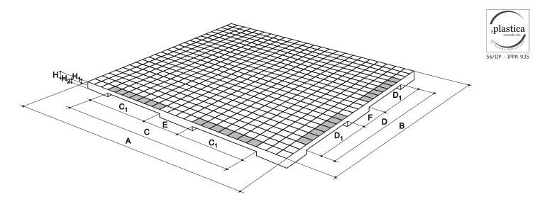
La plateforme est une solution optimale pour obtenir des sols facilement amovibles. Surface grillagée antidérapante, également résistante à l'action de l'humidité, elle ne nécessite d'aucun entretien.
