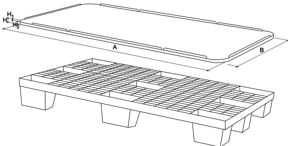
Il pianale per pallet è completamente chiuso e liscio e si adatta a qualsiasi pallet 800x1200. Può essere impiegato come coperchio per carico su bancale. Ha bordi di contenimento perimetrali, opportunamente interrotti per consentire un comodo impiego della reggia.
