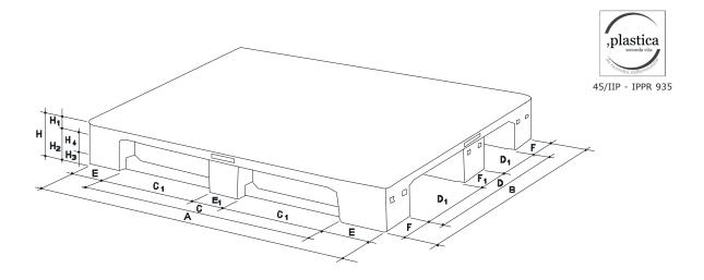
El PALET My-P 1000x1200 con plataforma lisa y completamente cerrada, lleva bordes perimetrales de contención que impiden la salida de la carga. Es una solución eficaz para todos los ámbitos industriales o comerciales. Con patines robustos se desplaza fácilmente y es apto para un uso intensivo.
