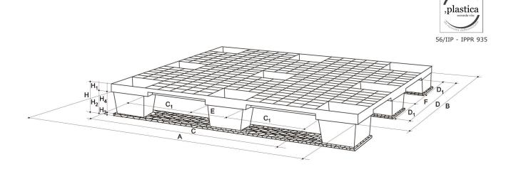
I PALLET My-N BIS 1000x1200, dotati di travette, sono più robusti e sono utilizzabili anche da carrelli elevatori con forche rotanti. Sono un'efficace soluzione ai problemi logistici in ogni realtà industriale o commerciale. Leggeri e resistenti, dotati di isolamento elettrico ottimale sono facilmente movimentabili e si prestano per un utilizzo intensivo. Mantengono la tara costante nel tempo e sono quindi ideali anche in impianti di imballaggio computerizzati.
