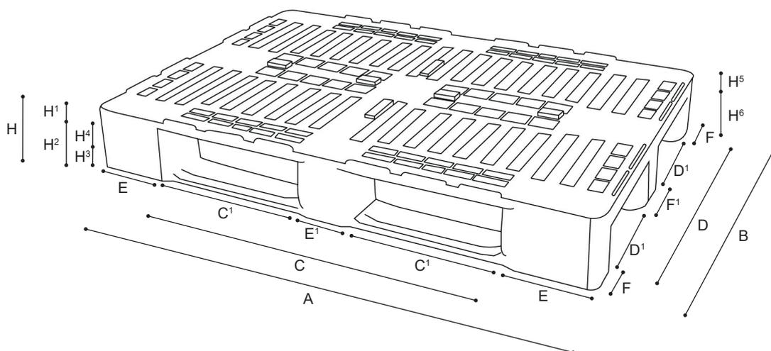
Diese Standard-H1-Palette mit 7 mm hohen Zentrierblöcken ist das ideale Werkzeug für alle, die eine robuste und nachhaltige Kunststoffpalette suchen. Dank der 3 Träger, die die Handhabung erleichtern, stellt es die ideale Lösung für den Transport schwerer und stapelbarer Lasten auf Regalen dar, beispielsweise Komponenten für alle Leicht- und Schwerindustriebereiche.
