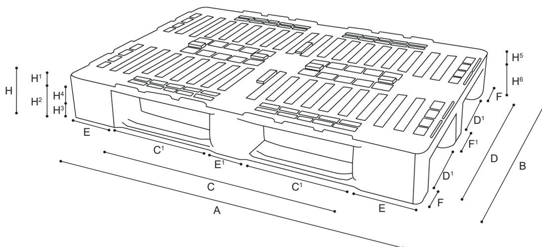
Cette palette standard H1 avec blocs de centrage de 7 mm de hauteur est l'outil idéal pour tous ceux qui recherchent une palette plastique robuste et durable. Grâce aux 3 poutres qui facilitent la manipulation, il représente la solution idéale pour le transport de charges lourdes et empilables sur racks, telles que des composants pour chaque secteur industriel léger et lourd.
