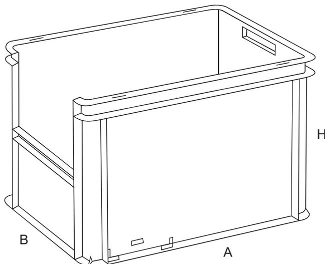
La version 70 OPEN du container DELTA MEC est superposable et par conséquent adapte aux installations automatisées, et en plus la paroi ouverte facilite la prise du matériel.
