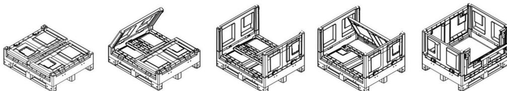
El Cargo Fold 700 con travesaños es completamente plegable. En caso de transporte o almacenamiento de los contenedores vacíos, permite un ahorro volumétrico del 63%, es decir que una pila de 8 contenedores plegados es alta como una pila de 3 contenedores no plegados.
