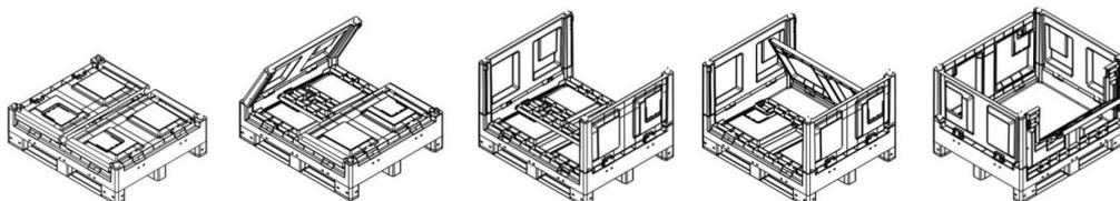
Cargo Fold 700, el primer cargopallet de paredes abatibles disponible con ruedas, se vuelve todavía más flexible y siempre listo para satisfacer todas las exigencias de transporte y almacenamiento. Ruedas especiales de poliamida blanca, fijadas a la base del Cargo, travesaños de acero galvanizado en caliente para garantizar resistencia y estabilidad a la carga y permitir el uso con cargas gravosas de hasta kg 600.
