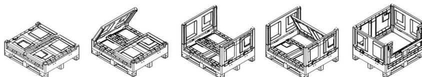
Cargo Fold 700 con travette è completamente ripiegabile e permette di guadagnare il 63% di volume in caso di contenitori vuoti da trasportare o a magazzino: una pila di 8 contenitori chiusi è alta come una pila di 3 contenitori aperti.
