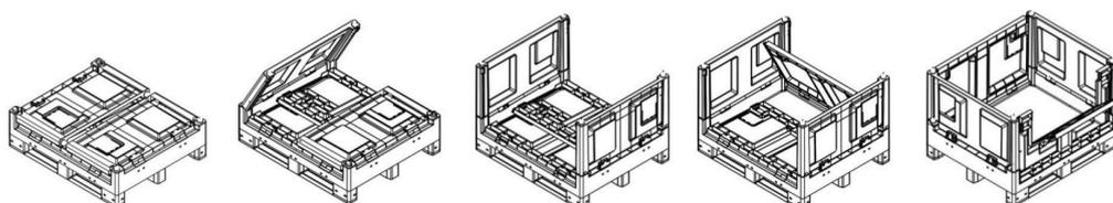
Cargo Fold 700 avec semelles est complètement pliable. Dans le cas de cargo entreposés ou transportés à vide vous réalisez un gain de 63% de volume. Huit Cargo Fold 700 pliés atteignent la même hauteur que trois Cargo dépliés. Le gerbage de la Cargo Fold 700 est sécurisé par 4 guides cylindres/sphériques dans les quatre angles sur lesquels les pieds viennent s'emboîter. Par ailleurs les 35 mm d'emboîtement assurent la sécurité maximale et la stabilité de la caisse-palette lors du gerbage.
