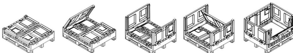
Cargo Fold 700 est le premier cargopallet avec parois rabattables disponible sur roulettes. Ses roulettes spéciales en polyamide blanc, fixées à la base du Cargo, sont dotées de traverses spécifiques en acier zingué à chaud qui garantissent la bonne tenue et la stabilité du chargement, en permettant ainsi l'emploi même avec des charges importantes, jusqu'à 600 kg.
