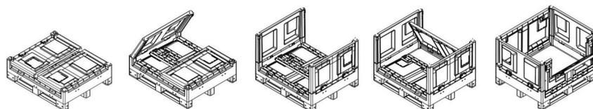
Cargo Fold 700 con portello e travette è completamente ripiegabile e permette di guadagnare il 63% di volume in caso di contenitori vuoti da trasportare o a magazzino: una pila di 8 contenitori chiusi è alta come una pila di 3 contenitori aperti.
