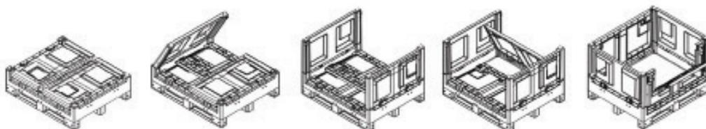
Cargo Fold 700 avec porte est le premier cargopallet avec parois rabattables disponible sur roulettes. Ses roulettes spéciales en polyamide blanc, fixées à la base du Cargo, sont dotées de traverses spécifiques en acier zingué à chaud qui garantissent la bonne tenue et la stabilité du chargement, en permettant ainsi l'emploi même avec des charges importantes, jusqu'à 600 kg.
