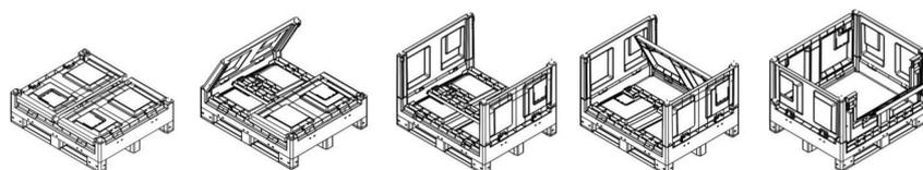
Cargo Fold 700 grigliato con travette, specifico per il settore agroalimentare, è completamente ripiegabile, permette di guadagnare il 63% di volume in caso di contenitori vuoti da trasportare o a magazzino: una pila di 8 contenitori chiusi è alta come una pila di 3 contenitori aperti.
