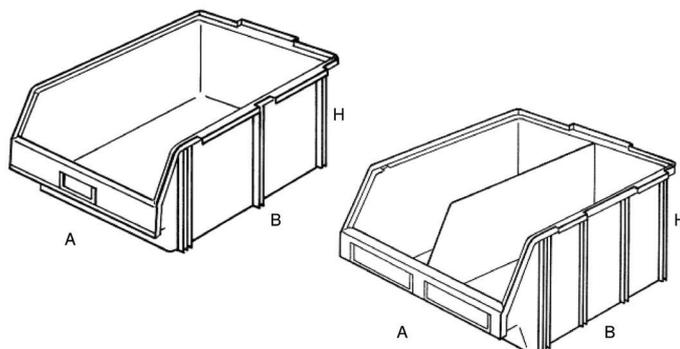
I multicomponibili ALFA sono gli unici contenitori autoportanti a bocca di lupo in grado di creare delle pareti di magazzino senza alcuna necessità di sostegni, ripiani o scaffali. Sono sovrapponibili, agganciabili lateralmente, completi di porta-etichetta frontale. Il modello ALFA BIS è caratterizzato da un separatore centrale fisso.
