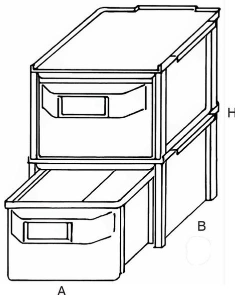
Leichter Schubladenschrank, selbsttragend und selbst zusammenstellbar, für Lagerwände aller Größen. Ausziehbare und übereinander positionierbare Schubladen, auch in der Version öl-, fettund lösungsmittelbeständig.
