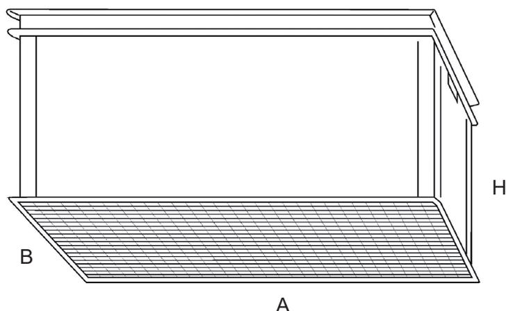
Stoßfeste, chemikalien- und feuchtigkeitsbeständige Behälter, nutzen die gesamte Fläche der europäischen Standardpalette und optimieren dank der vertikalen Wände den internen Platz. Übereinander positionierbar und mit durchgehenden oder geschlossenen Griffen eignen sie sich für pharmazeutische Präparate und metallische Kleinteile und stehen für Lebensmittel auch aus ungiftigen Materialien oder gegen statische Aufladung aus leitfähigem Material zur Verfügung.
