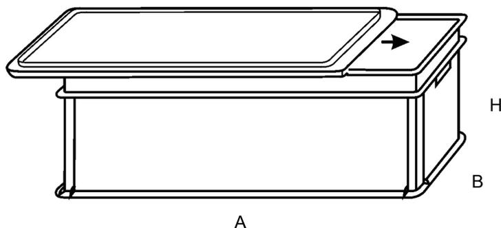
Selbsttragende, vielfach zusammensetzbare Behälter zum Realisieren von Lagerwänden auch in Werkstätten und Montagehallen. Aus stoßfestem Kunststoff, dank der vorderen Öffnung leicht zugänglich, können übereinander angeordnet werden, sind modular und stehen in vielen Formaten zur Verfügung. Die Modelle 5, 6 und 7 sind mit zentraler Scheidewand zu haben (Version bis) und durch 2 Etikettenhalter an der Vorderseite.
