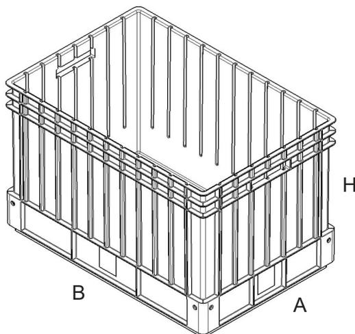
Stapelbare Behälter, geschlossene Wände, gerippter Boden, offene Griffe, glatte und abgerundete Außenecken, aus industriellem Copolymer-Polypropylen.
