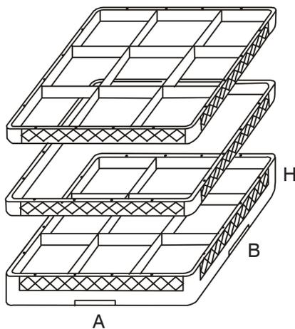
**DIE KÖRBE** haben perforierte Wände, die ein besseres Waschen und perfektes Trocknen gewährleisten, wobei Kalksteinformationen reduziert werden.
